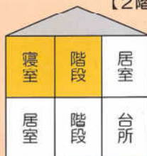
b 2階に寝室がある。 寝室と階段に設置
