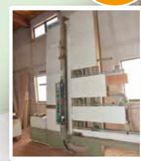
↑板材をカットする大型機械
