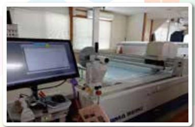
↑自動裁断機CAM。コンピュータにデータを打ち込むと、大きな布をあっという間に指示どおりの形に裁断します
