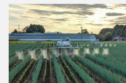
自立走行型ロボットによるねぎの農薬散布
