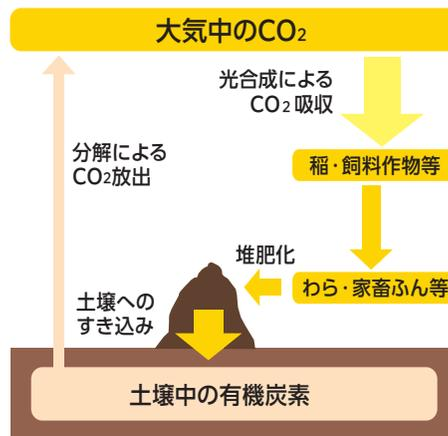
わらや家畜ふん等から製造した堆肥を土壌にすき込むことで、稲や飼料作物が生育中に吸収したCO<sub>2</sub>を有機炭素として土壌中に蓄積。土壌中の有機炭素は時間とともに分解されるが、分解される有機炭素の量よりも土壌に入る有機炭素の量が多ければ土壌中の有機炭素量は増加する。
