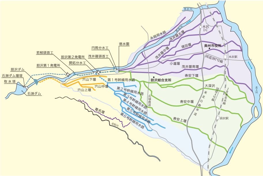
寿安堰は北側に流れる低い胆沢川から、南側の丘陵状に高くなる方向へ水を引いている。寿庵の土木技術の高さがうかがえる
