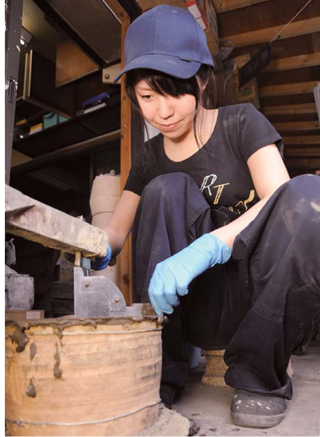
木型を回して鑄型を作る「型挽」の工程
