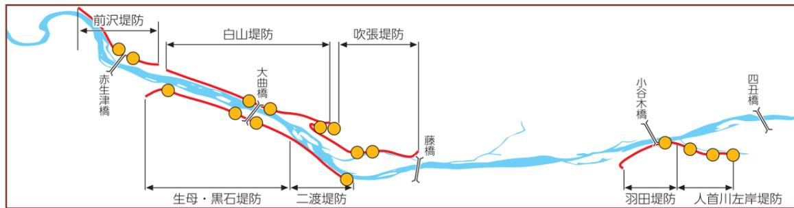
河川堤防は、市民皆さんの生命と財産を守る大切な施設です。堤防上は、進入を制限する注意看板や仮設バリケードにより、一般車両の通行を規制していますが、通り抜けや河川敷への不法投棄などが後を絶ちません。このため、各堤防の上下流端および仮設バリケードの設置箇所に**車止め**を設置します。
