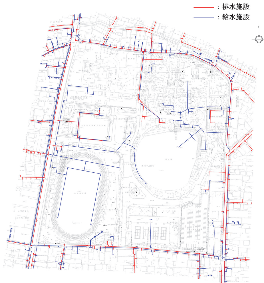
【上下水道(給排水施設) 現況】
