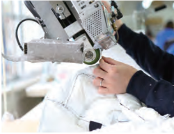
雨や冷気の侵入を防ぐシームテープ加工。見えない部分にも施される。
